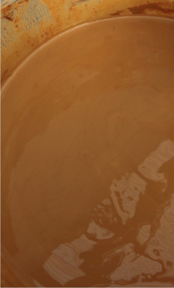
↓ Terre fine préparée sous forme de barbotine liquide
