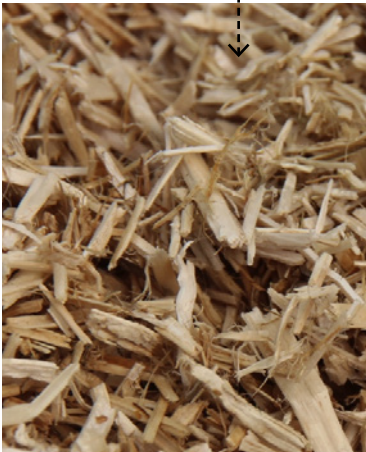
↑ La plante de chanvre récoltée puis séchée permet d'obtenir, après défibrage et broyage de la tige de la plante, deux co-produits : des fibres (issues de l'enveloppe extérieure de la tige) et des particules de bois appelées chènevotte.
