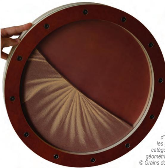
*Figure 6 : Un mélange de grains de différentes tailles est placé dans un disque que l'on peut faire tourner sur son axe, comme une roue de vélo.*
