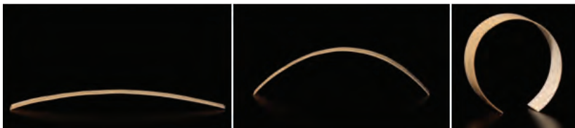
Une feuille de bois dont la face supérieure est humidifiée s'enroule spontanément (voir la vidéo : https://vimeo.com/144339320 )
