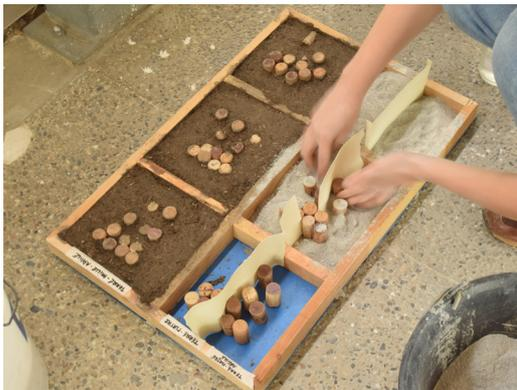
Mise en oeuvre du mélange terre-plâtre, à sec et à l'horizontale
