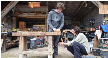
Boudin glissé au bord de la table, pour vérifier les ruptures
