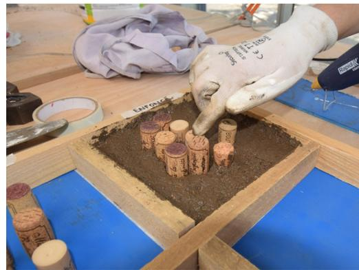
Bouchons enfoncés dans l'enduit
